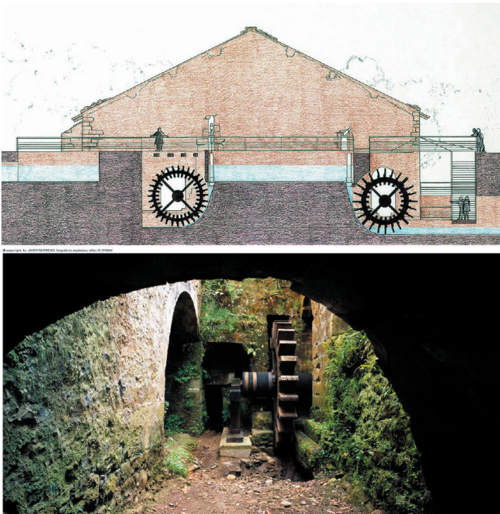
Fig. 13 Cantabria. La ferrería de Cades Origen 1752 Restauración 2010 Arquitectos Luis Azurmendi y M. a Angeles Gómez Carballo Maquinaria Reconstrucción total. Material tradicional Copia tratados XVIII. Edificio Parte original conservada Restauración y limpieza Parte reconstruida Criterio: distanciar los elementos nuevos de los originales Cubierta Luz cenital perimetral Suelos No tocar ni muro, ni suelo Reversibles Nuevos materiales: acero Molino: existente Entorno: intervención sobre itinerarios
