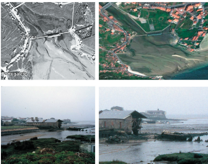
Fig. 16 Galicia. Molino de Cachón. Entorno medioambiental La morfología natural del estuario esta preparada para los fenómenos adversos. con zonas de reserva de inundaciones que reducen la velocidad del agua. Si se cierran, la velocidad fluvial y mareal aumenta Se producen fenómenos de empujes y erosión instantánea. El riesgo aumenta con la coincidencia sicciga de riadas y mareas vivas Suceso en Muros durante la ciclogénesis de 1994
